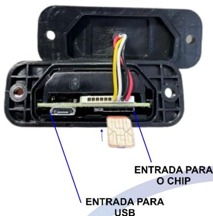
Figura 5 – Encaixe SIM Card
